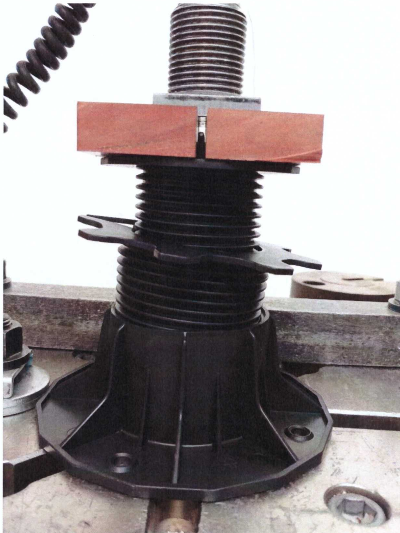
Fot. 3 Postać zniszczenia przy ściskaniu wspornika ET 66 – 145 mm
